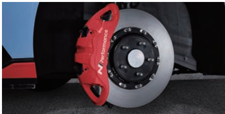
N 퍼포먼스 브레이크 시스템 (모노블록 4피스톤 캘리퍼, 불팅타입 하이브리드 디스크)
